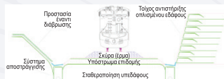
Σχήμα βασικών εφαρμογών γεωσυνθετικών σε σιδηροδρομικά έργα
