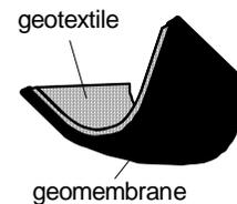
**土工合成材料粘土衬垫 (GCLs)** 通常是在两层土工织物之间夹有膨润土层或把膨润土层粘结在一层土工膜上或单层土工织物上制成的复合材料。土工织物外包的 GCLs 常常是缝合或针刺穿过膨润土核心以提高内部抗剪强度。当水化时它们作为液体或气
