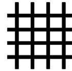
**土工网**是由两组粗糙、平行的挤出聚合物束以一恒定的锐角相交形成的开放式网格状材料。这种网络形成了带平面内孔隙的层，可用来传导相对大的液流或气流。
