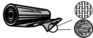
**土工格栅**是具有开放式网格状外观的土工合成材料。土工格栅主要用于土的加筋。
