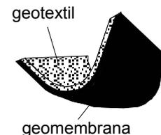
**Revestimientos geosintéticos de arcilla (GCL's)** son geocompuestos que son prefabricados con una capa de arcilla bentonítica típicamente incorporada entre una
