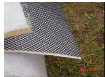
Géocomposite en drainage
