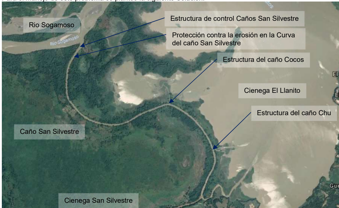
Ilustración 3: Obras a construir para mejorar las condiciones de la Ciénaga el Llanito y San Silvestre.
