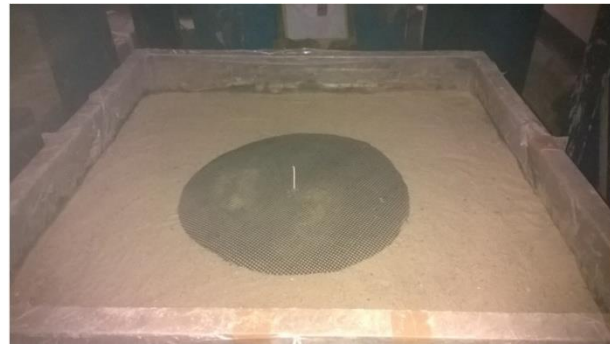
(d) Placement of geogrid over 5 mm thick sand
