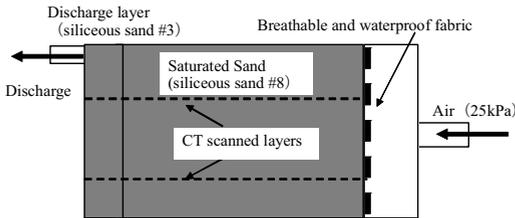
Fig.4. The test apparatus
