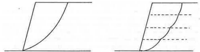
Abb. 3.1. a) Bruch des gesamten Damms (links) b) Bruch der einzelnen Lagen (rechts)
