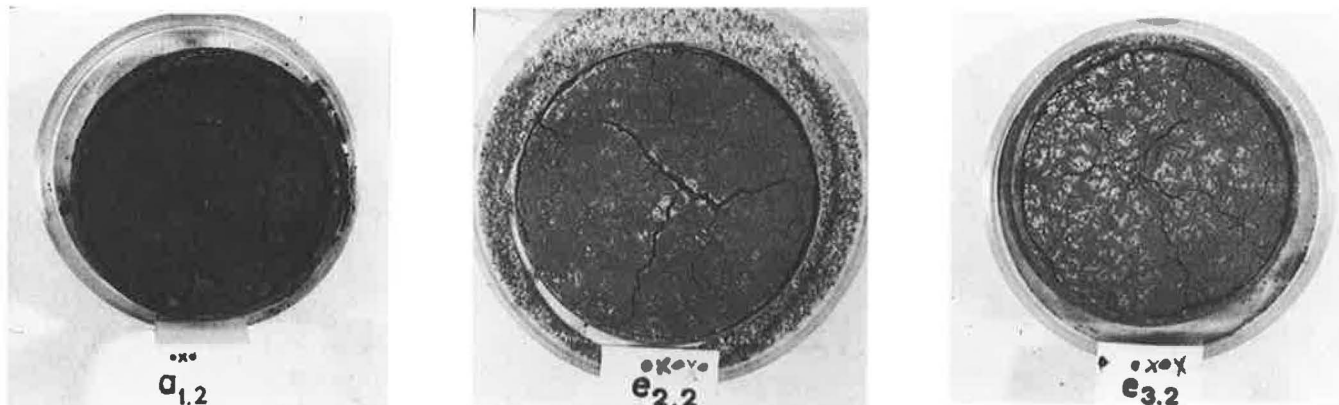
Photos 1-3. Le comportement à l'humectation-séchage des mélanges type F: a 1.2 - témoin après 3 cycles; e 2.2 - terre F plus duvet 0,5% - 5 cycles; e 3.2 - terre F plus duvet 1% - 6 cycles.
