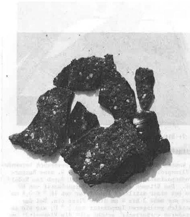
Abb. 8: Bitumenprobe mit eingedrückten Körnern
