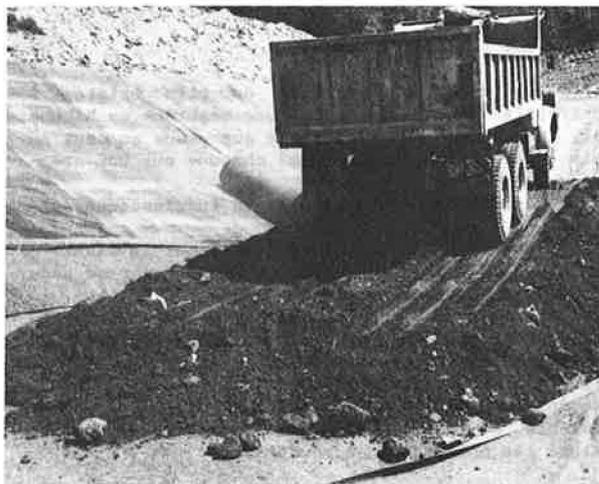
Vue 1 - Essai de poinçonnement
