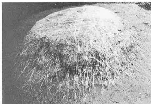
Figure 5 - Masse de sable traité ayant subi une attaque de 20 minutes au jet d'eau.
