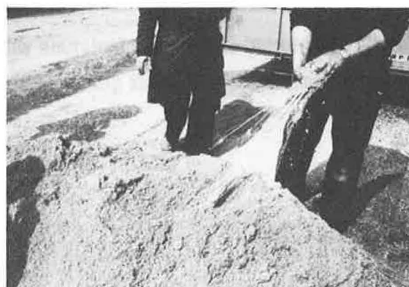
Figure 2 - Volume de sable traité à faible dosage (environ 0,5 pour mille). Fils tirés de la masse.
